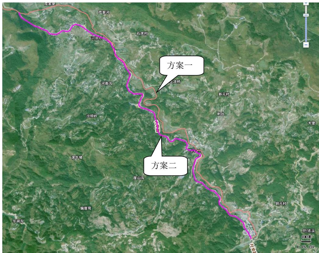
图 2.21-2 灌溉管道(胡家坝村至原石笋隧道部分)布置比选示意图
