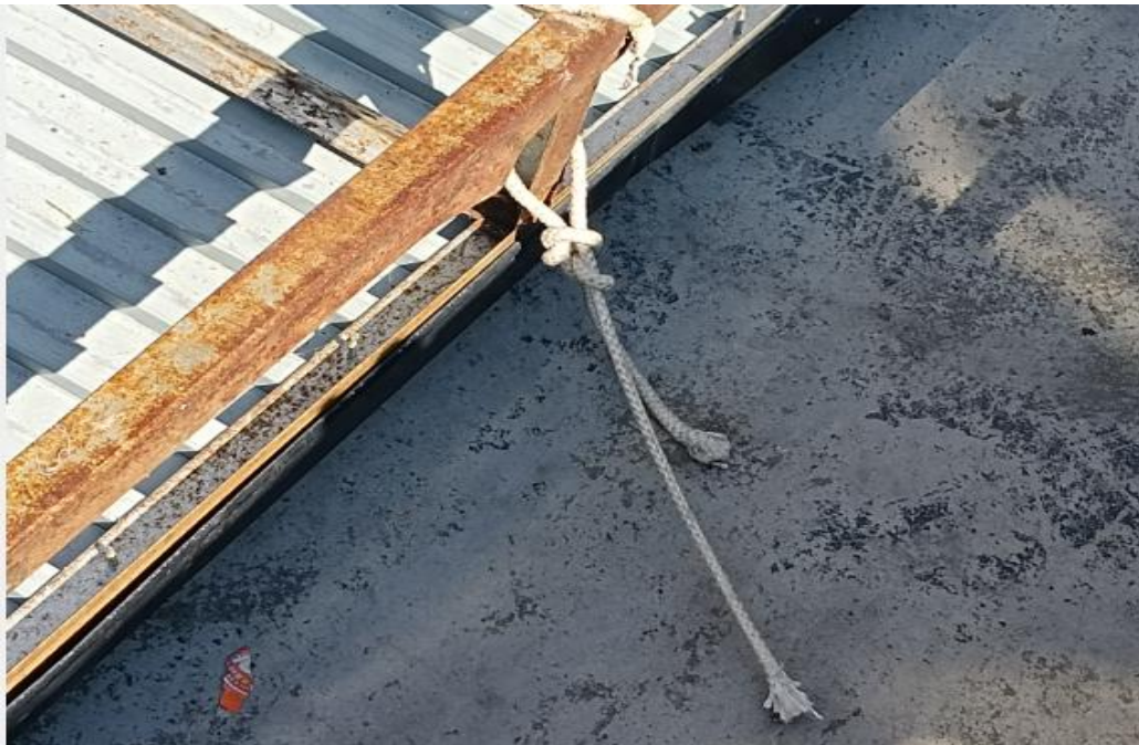
图三、程**绑定广告牌的尼龙绳断开部分
