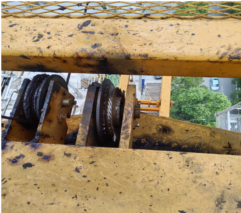
图五：1#塔机过度节主钢丝绳转向滑轮（远景图）
